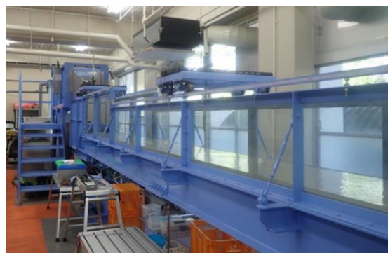
Fig. 2 実験に使用した開水路 An open channel used in the experiment
